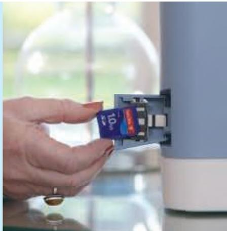
Tarjeta SD de 1 GB para almacenar hasta 1 año de datos de ventilación.
